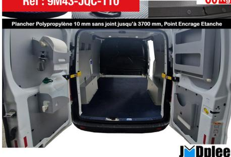
**VITO EXTRA LONG-Kit + Portes Ar Plancher Antidérapant Polypropylene Light 1 Plc**
