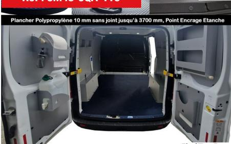
Plancher Polypropylène 10 mm sans joint jusqu'à 3700 mm, Point Encrage Etanche
