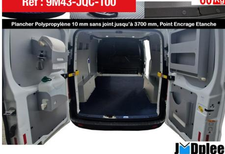
**VITO EXTRA LONG-Kit + Portes Ar Plancher Antidérapant Polypropylene Light 0 Plc**
